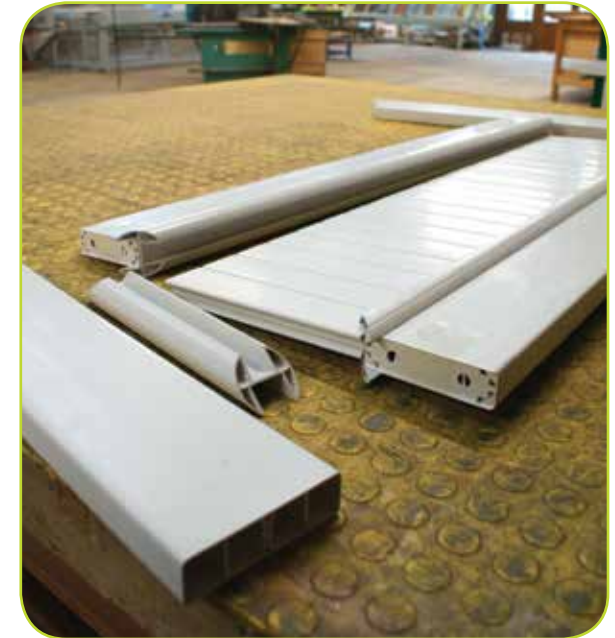
Détail assemblage traverse (Tube équerre)
