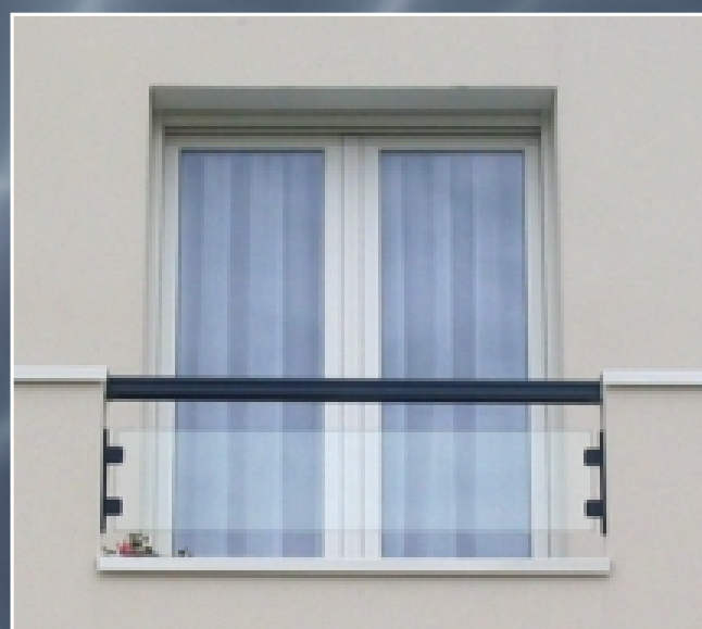
Modèle GARDE 06 Main courante de 71x52 mm, vitrage 44/2 clair Fixation par un méplat en tableau + pince — Option vitrage bronze ou gris ou opaque blanc — Option teintes chêne — Option croix de ST André (Sauf options chêne)
