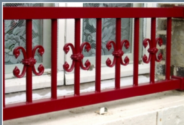
Modèle GARDE 02 Lisse de 40x40 mm, barreaudage Ø 20 mm Décor volute double - Option décor volute palme ou fourreau
